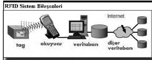
Şekil-1: RFID Teknolojisi Sistem Bileşenleri
